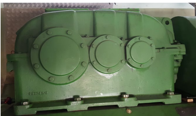
Getriebe Schneckenpumpen, verlängerte Revisionsintervalle
